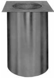
Der rohrartige Eintrittsschalldämpfer besitzt auf der dem Dachventilator zugewandten Seite einen quadratischen Flansch, passend zur Befestigung auf dem entsprechenden Flachdachsockel. Er taucht in den Flachdachsockel ein und an das untere Ende kann dann entweder eine weiterführende Rohrleitung oder eine Einströmdüse montiert werden.
