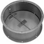
Selbsttätige Verschlussklappen ZLK 01 wirken bei Stillstand des Dachventilators als Rückschlagklappe und verhindern ungewollten Kaltluftzufall. Infolge von Wirbelbildung an den Klappenblechen erhöhen sich bei angebaute Verschlussklappe ZLK die eintritts- und austrittsseitigen Geräuschwerte um je ca. 3 dB.
