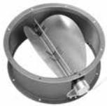
Motorbetätigte Verschlussklappen ZLK 21 steuern den (mechanisch oder natürlich erzeugten) Abluftstrom auch bei außer Betrieb befindlichen Dachventilatoren oder bei Dachlüftungshauben. Sie geben bei Einschalten des Klappenmotors die Abluftöffnung frei und schließen nach dem Ausschalten automatisch. Im Parallelbetrieb mit dem Dachventilator wirken sie wie selbsttätige Verschlussklappen.
