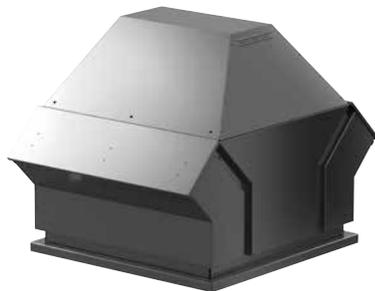
**RDM 3E/FE... F/P/BI... Dachventilator mit Druckregelung mit drallfrei gerichtetem, vertikalem Luftaustritt, geeignet für Fördermediumstemperaturen bis ca. +60 °C. Geschlossenes, formschönes Gehäuse aus korrosionsbeständigem Aluminium.**
