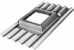
Welldachsockel aus glasfaserverstärktem Polyester lösen das Montageproblem von Dachventilatoren auf Welldächern (Wellabstand 177 mm) bis 25° Dachneigung.
